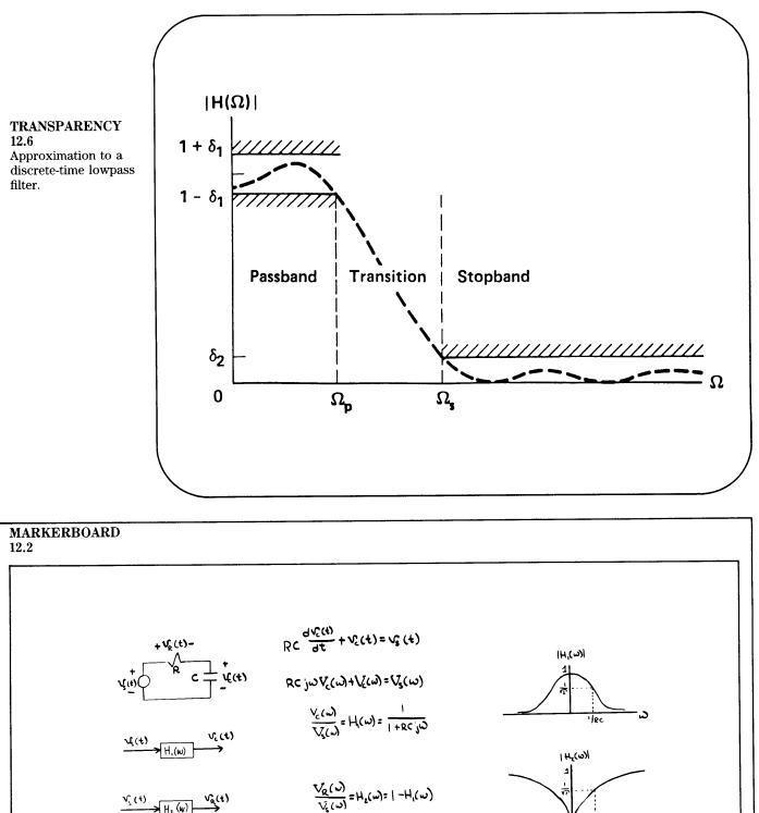
$|H_2(\omega) = \frac{Rc_j\omega}{1+Rc_j\omega}$
